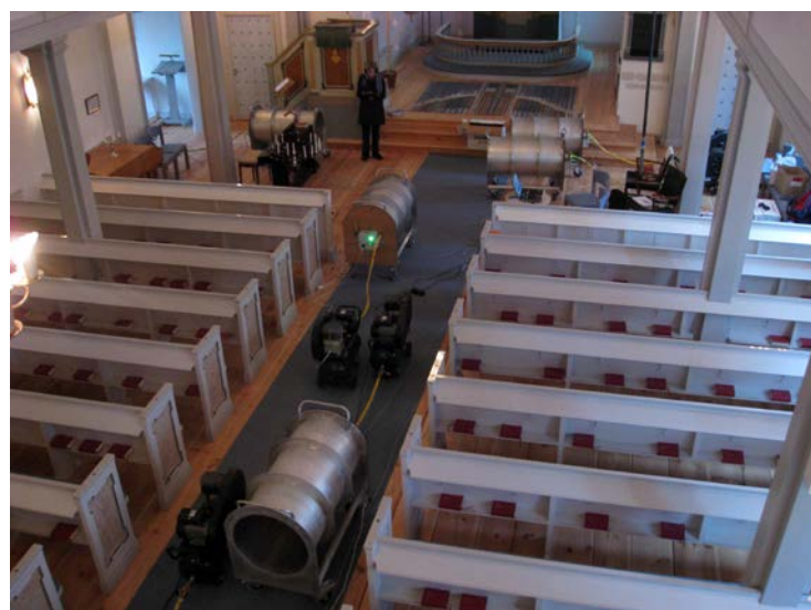
Figur 1. Täthetsmätning av byggnadsskalet genom: Vänster : Trycksättningsfläktar i kyrkport, ”blower door”-teknik; Höger : Tryckpuls test med ”Luftkanoner”.
