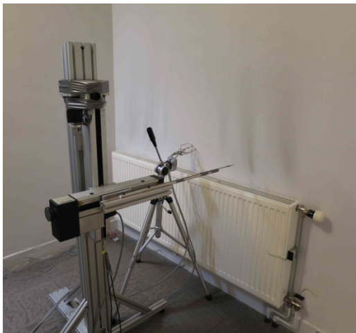
Figur 25. Mätning av mikroklimatet över en radiator.
