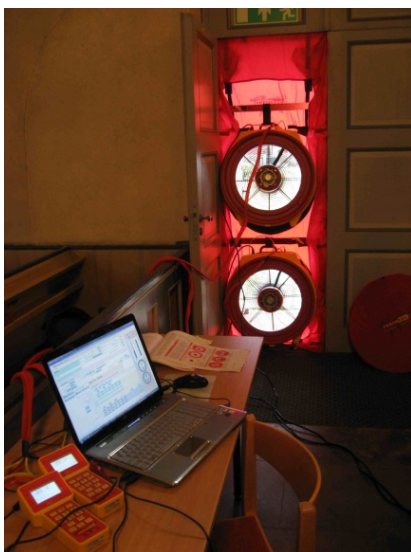
Figur 1. Täthetsmätning av byggnadsskalet genom: Vänster : Trycksättningsfläktar i kyrkport, ”blower door”-teknik; Höger : Tryckpuls test med ”Luftkanoner”.
