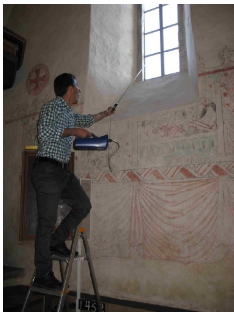
Figur 13. Sökning efter luftläckage med hjälp av portabel partikelräknare.
